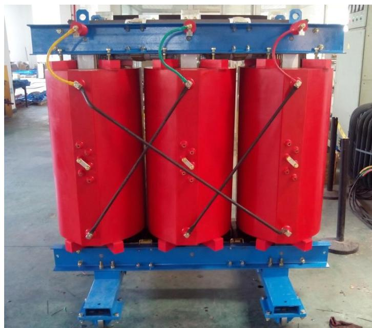
приспособленное под установку съемных колес-роликов для перемещения трансформатора по полу до места установки (при длительной транспортировке и перевозке колеса снимаются). Основание и балки имеют проушины для перемещения и транспортировки, а также для закрепления трансформатора в месте установки. На балках также предусмотрены конструктивные элементы для подключения заземления (минимум 2 терминала), установки КИПиА.
