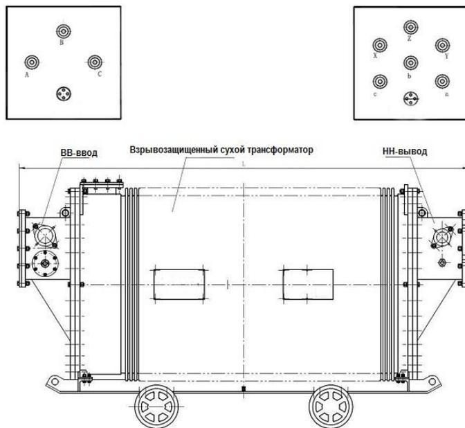
Таким образом, производимые нами трансформаторы ТСШ, ТСШВ готовы для применения на опасных объектах, имеют высокую стойкость к нагреву, выдерживают высокие перегрузки и короткие замыкания, часто случающиеся при эксплуатации «в полях», то есть при отсутствии возможности проведения регулярного полного техобслуживания. Все это позволяет Вам использовать трансформаторы ТСШ(В) в особо опасных объектах: прежде всего, шахты, рудники, химические производства разного рода, фабрики, ГОКи, карьеры.
